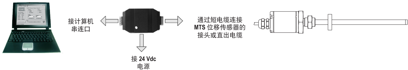
图 1：G-系列传感器与计算机的连接示意图
